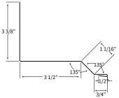
6. EAVE DRIP/EAVE **FLASHING** ED-1/EF-3
